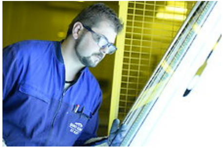
Başlık : Opérateur contrôlant la sérigraphie d'un vitrage automobile à l'usine Saint-Gobain Sekurit d'Aviles (Espagne) Yazar : Franck Dunouau Telif Hakkı : Saint-Gobain
